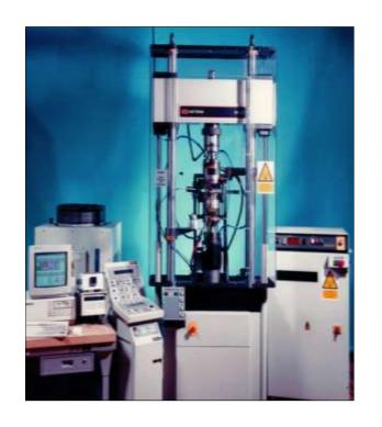
Сервогидравлическая испытательная машина 8801 Двухколонная рама нагрузки Нагружающая способность 100 кН Встроенные гидравлические подъемники для перемещения траверсы Применяется для испытания материалов и изучения механизмов образования и роста усталостных трещин
