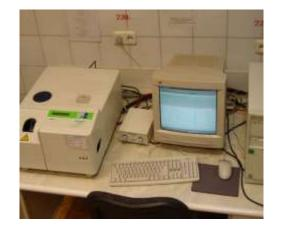
Дифференциальный сканирующий калориметр «DSC 821» фирмы «Mettler Toledo», Швейцария
